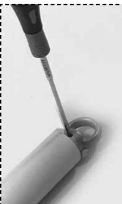
6 Riavvitare l'anello di sospensione sulla tiges fino a fine corsa e bloccarlo avvitando il grano.
