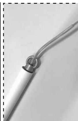
5 Tagliare a misura le tiges e tagliare l'asta di copertura 1 cm in meno di lunghezza e infilare le tiges nel tubo.
