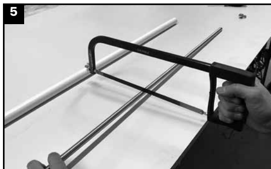
5 Tagliare a misura le tiges e tagliare l'asta di copertura 1 cm in meno di lunghezza e infilare le tiges nel tubo.
