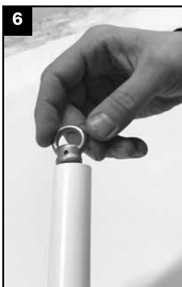
6 Riavvitare l'anello di sospensione sulla tiges fino a fine corsa e bloccarlo avvitando il grano.
